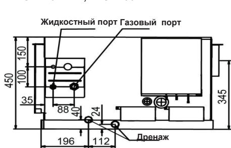
Вид трубопроводов с боковой стороны
