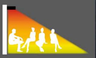
Благодаря особой форме рефлектора достигается идеально ровный обогрев, включая пристенную зону. Такая конструкционная особенность увеличивает эффективность теплового излучения на ~15%, по сравнению со стандартными ИК-обогревателями.
