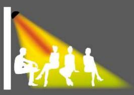
Стандартный ИК-обогреватель, установленный на стене под углом, имеет тепловое излучение, неравномерно распределяемое по рабочей зоне.
