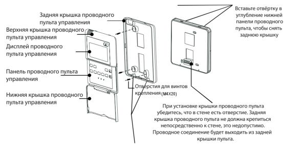
При установке проводного пульта необходимо отрегулировать нижнюю часть его панели относительно задней крышки, которую сначала нужно закрепить и только потом вставить другой конец панели проводного пульта.
