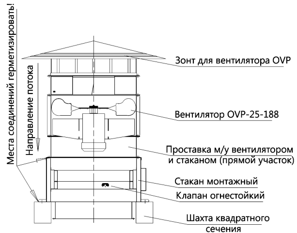
установка на монтажном стакане с огнестойким клапаном
