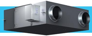
В изделиях для вентиляции MMD-VN(K) отводимый воздух + змеевик непосредственного испарения (DX) используются для предварительной подготовки поступающего воздуха. Это снижает нагрузку в режимах охлаждения и нагрева и общую мощность требуемой системы кондиционирования.
