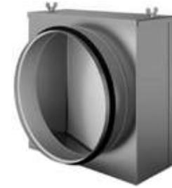
Кассетный фильтр SFK предназначен для очистки воздуха в круглых каналах систем вентиляции и кондиционирования промышленных и общественных зданий. Корпус фильтра SFK и крышка изготовлены из стального оцинкованного листа. Пластина фильтрующего материала выполнена из синте-
